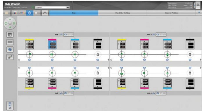
Das Registerregelungssystem mit MultiCam, in dem alle Druckwerke auf einen Blick angezeigt werden, sorgt automatisch für die Einhaltung der festgelegten Toleranzen beim Druck.
