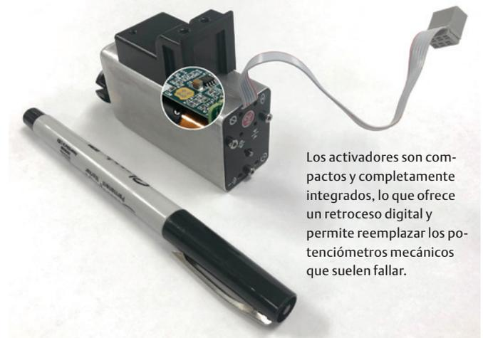
Los activadores son compactos y completamente integrados, lo que ofrece un retroceso digital y permite reemplazar los potenciómetros mecánicos que suelen fallar.
